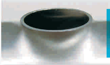
Aushalung an einem Edelstahlrohr Extrusion at a stainless steel pipe
