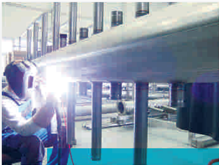
Ausgehalste Rohre bei der Weiterverarbeitung Extruded pipes at subsequent processing
